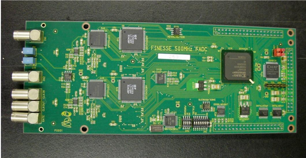
Figure 2.2: FINESSE 500-MHz FADC.
